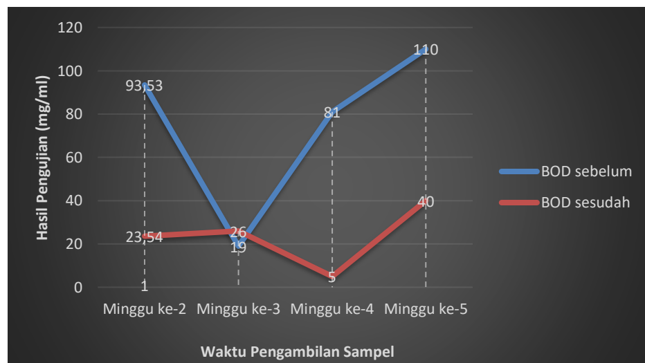
Grafik 5.8 Perbandingan Kadar BOD Air Limbah Sebelum dan Sesudah Pada Bak Kontrol di Puskesmas Rawat Inap 2016
