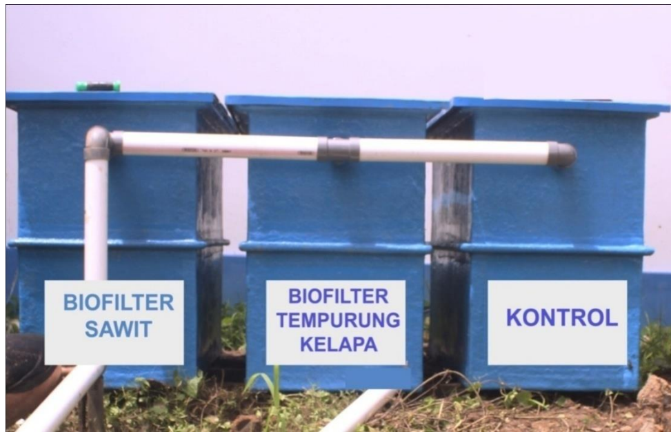
Gambar 9. Prototipe Pengolahan Air Limbah
