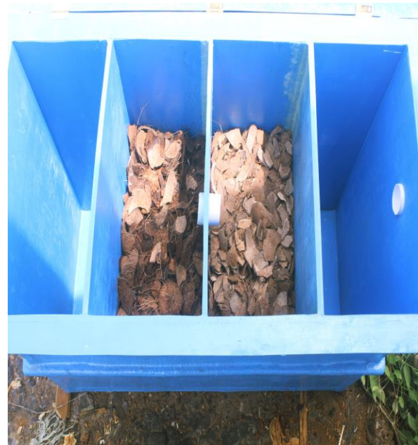
GAMBAR 4. BAK 2 TERISI TEMPURUNG KELAPA
